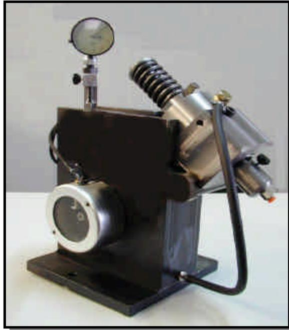
Il kit per sistemi pompa-iniettore "taglia grossa" consente di provare l'efficienza dell'unità pompa-iniettore.
