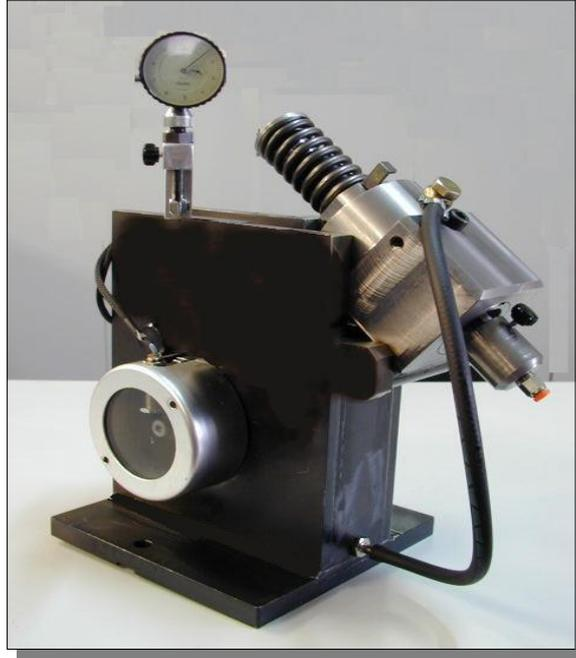
El kit para sistema bomba-inyector "talla grande" tiene la función de comprobar la eficiencia de la unidad bomba-inyector.
