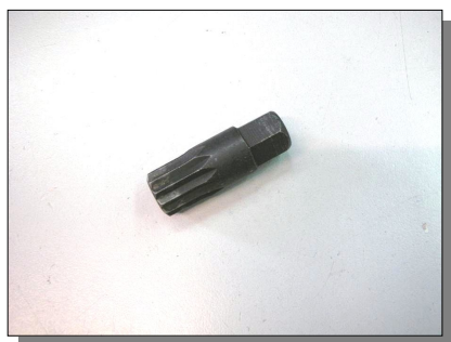
Ghiera valvola pilota per elettroiniettori common-rail autocarro 12 denti grande con attacco chiave da 12
