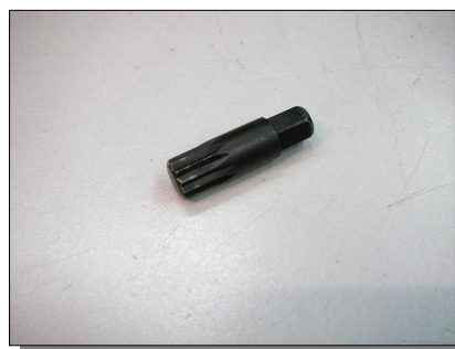
Ghiera valvola pilota per elettroiniettori common-rail autocarro 12 denti piccola con attacco chiave da 10
