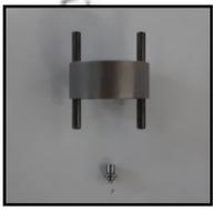
Nel caso degli iniettori Piezo elettrici Bosch si è stabilito con le nuove condizioni di prova che le pre-iniezioni molto più affinate alle precedenti, necessitano per il corretto funzionamento delle misure dell'alzata della servovalvola molto accurate che solo con il sistema Mitutoyo si possono fare. In altri casi tale sistema permette il riassetto corretto dell'iniettore con gli opportuni spessori dopo aver subito manipolazioni da avventori del diesel.
