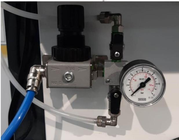
Il dispositivo pneumatico serve ad imprimere una forza costante e nota quando si effettua la misurazione sul 555-SP, in quanto assicura precisione e ripetitività delle misurazioni .
