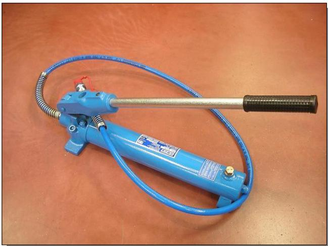
**Kit pompa idraulica per CD40-CMR**
