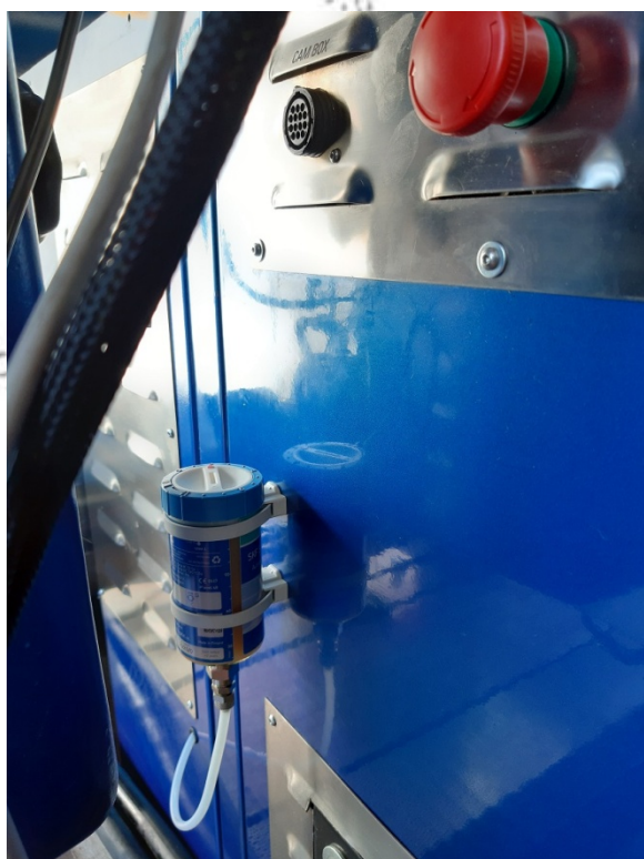
Cartuccia ingrassatore cuscinetto anteriore motore (posizionato sul lato anteriore del banco)
