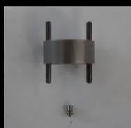
Nel caso degli iniettori Piezo elettrici Bosch si è stabilito con le nuove condizioni di prova che le pre-iniezioni molto più affinate alle precedenti, necessitano per il corretto funzionamento delle misure dell'alzata della servovalvola molto accurate che solo con il sistema Mitutoyo si possono fare. In altri casi tale sistema permette il riassetto corretto dell'iniettore con gli opportuni spessori dopo aver subito manipolazioni da avventori del diesel.
