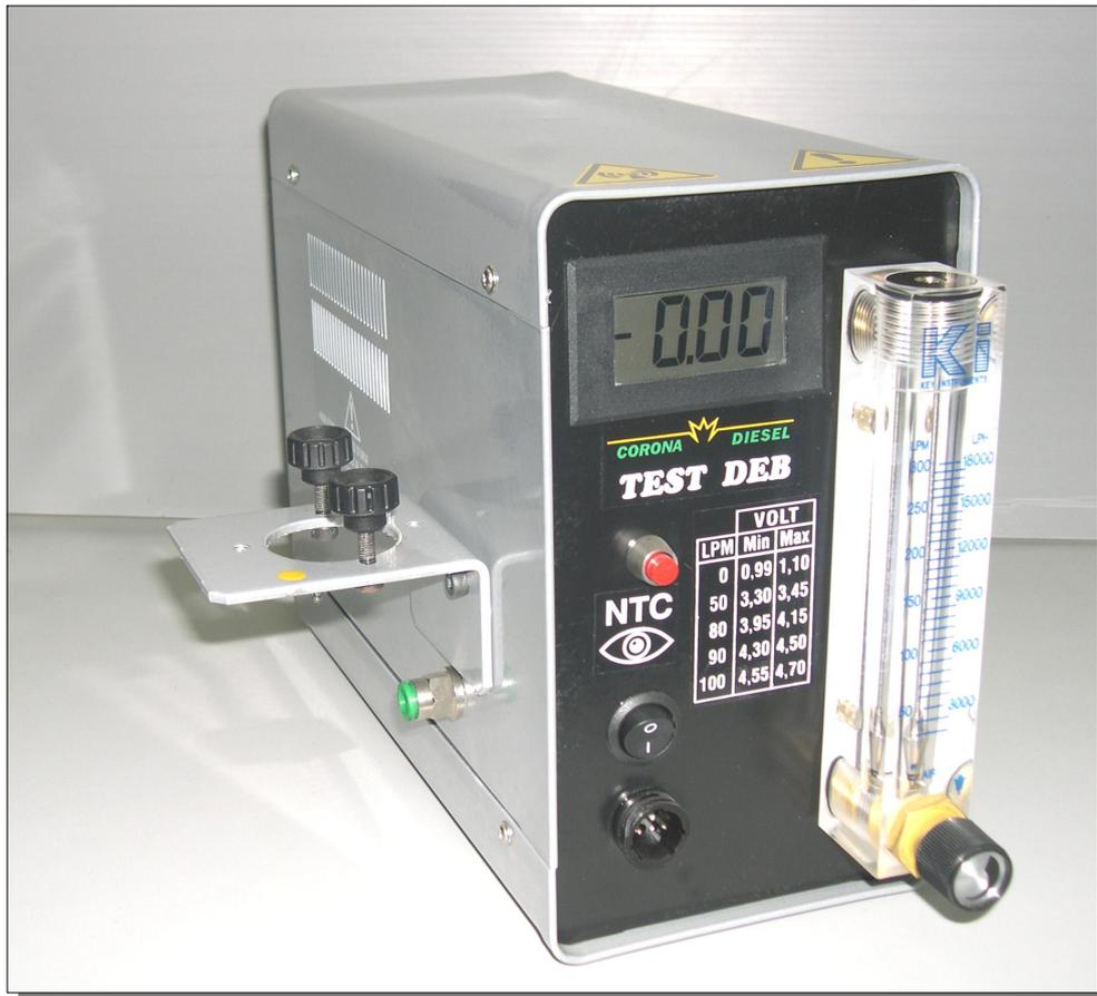
El tester prueba los medidores de masa de aire Bosch a film caliente (tipo A, B), somete la lámina de lectura a un flujo de aire que es ajustado por el flujómetro y proporciona en pantalla video una señal eléctrica que luego es importante comparar con los parámetros de la tabla. Al cumplir con la reparación del medidor se recomienda seguir las instrucciones del fabricante para su funcionamiento.
