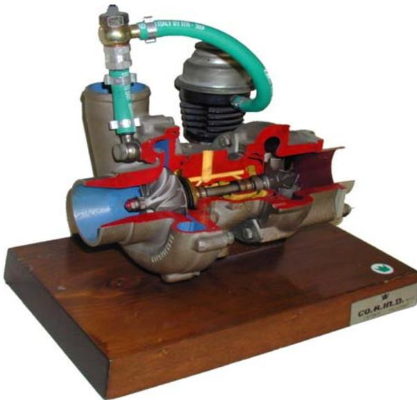
L’over-Boost è dotato di una vite di registro per incrementare la pressione del turbo fino al raggiungimento del valore desiderato.
